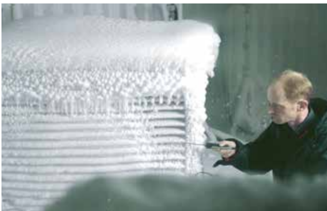
En la sala climática se analizan las unidades exteriores ante condiciones climatológicas extremas
