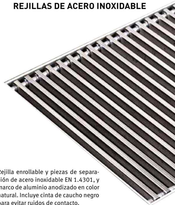
Rejilla enrollable y piezas de separación de acero inoxidable EN 1.4301, y marco de aluminio anodizado en color natural. Incluye cinta de caucho negro para evitar ruidos de contacto. Longitud máxima: 6 metros.
